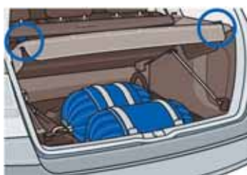
Zbiorniki gazu pod podłogą bagażnika
