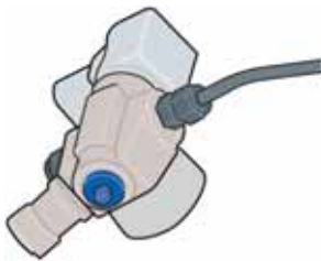
Ręczny zawór odcinający na zaworze głównym zbiornika
