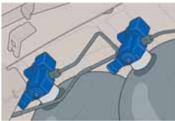
Elektromagnetyczne zawory odcinające na zbiornikach gazu
